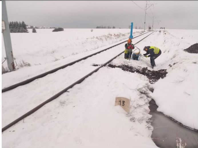
Foto 3: Střední dynamická penetrace DPM3
